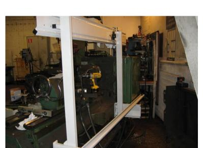
The next step is to install the energy transfer chain's C profile onto the top of the upright pillars where L -shaped fasteners are located.ärnäst ska energiöverföringskedjans C-profil monteras på de lodräta stolparna, i L-fästena.
